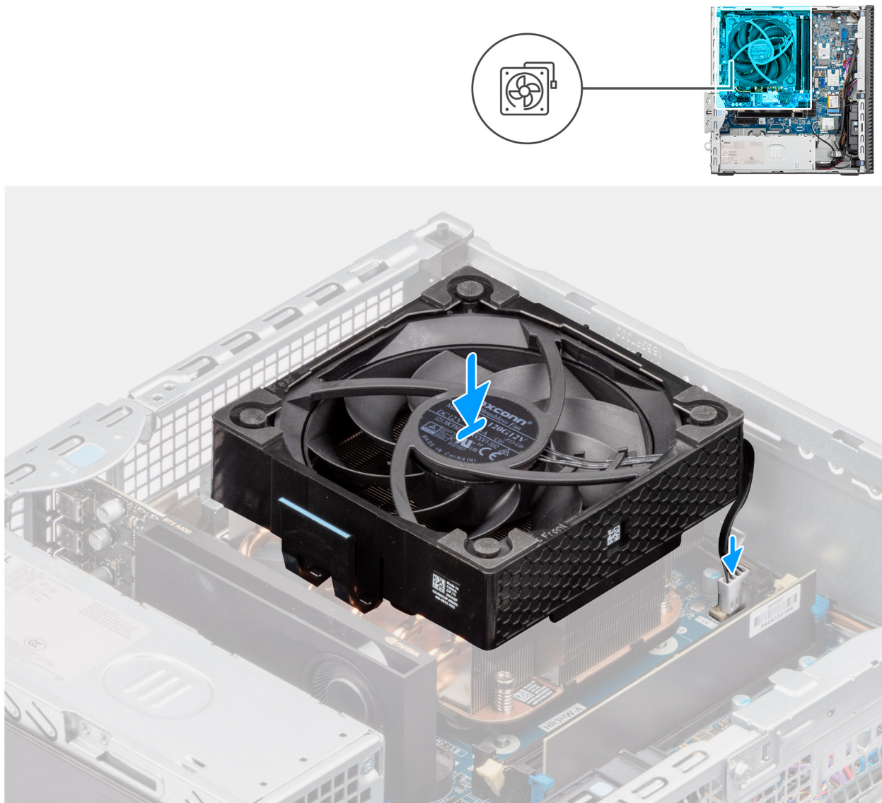
Obrázok 52. Montáž ventilátora procesora
