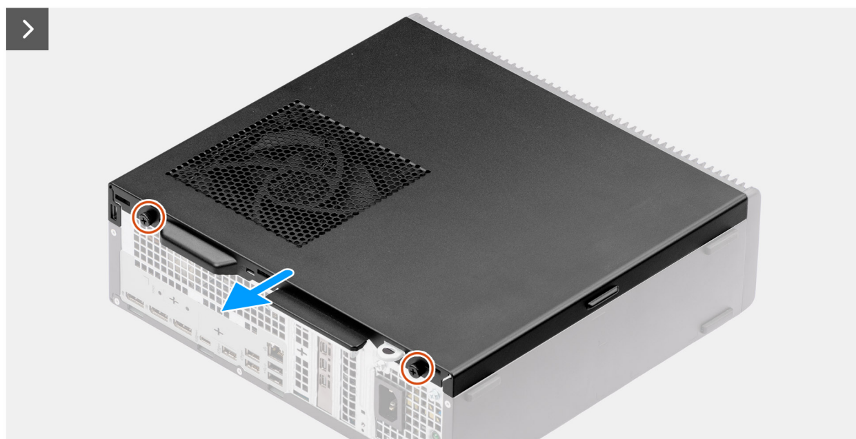
Obrázok 9. Odstránenie bočného krytu
