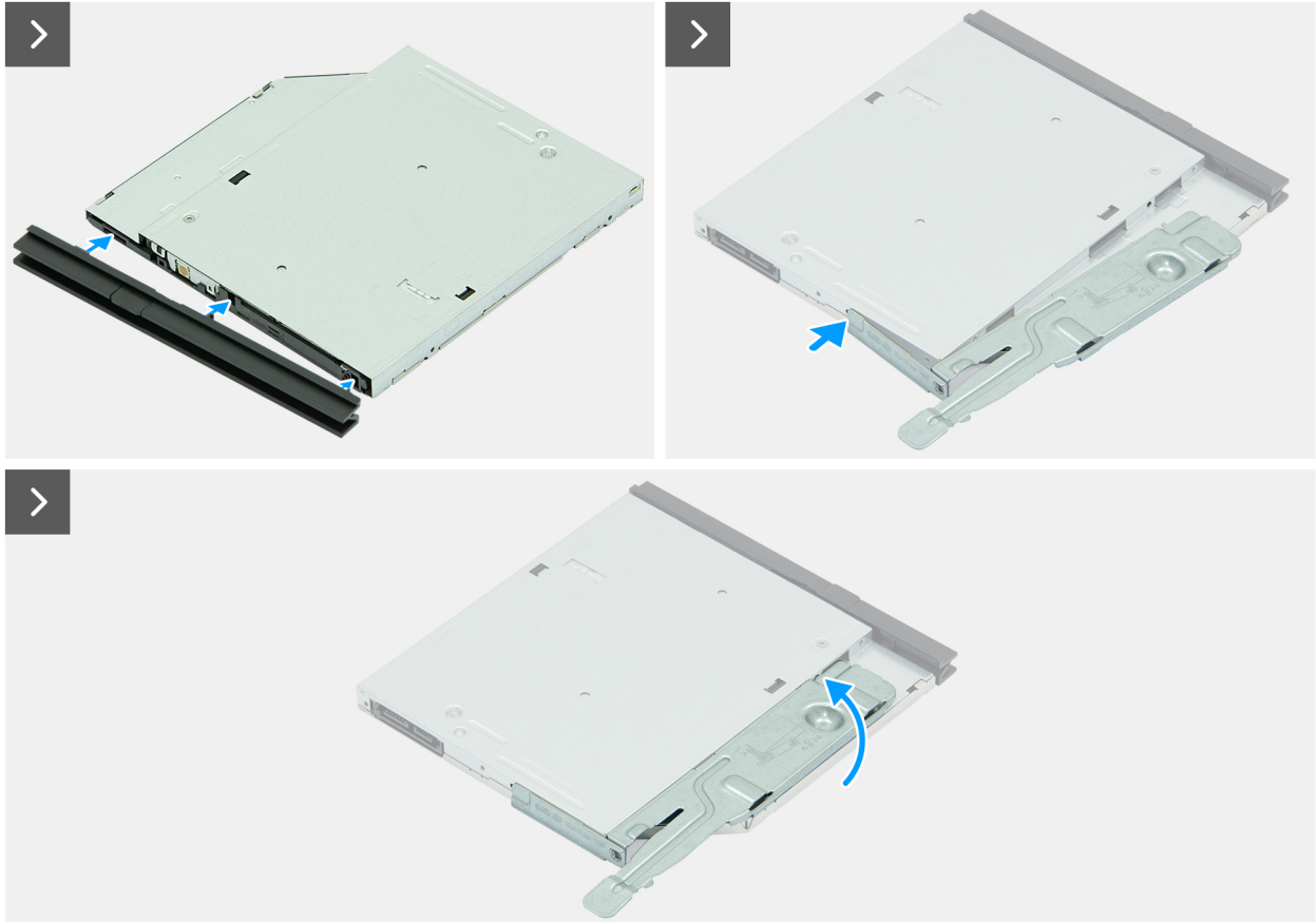
Obrázok 19. Montáž optickej jednotky
