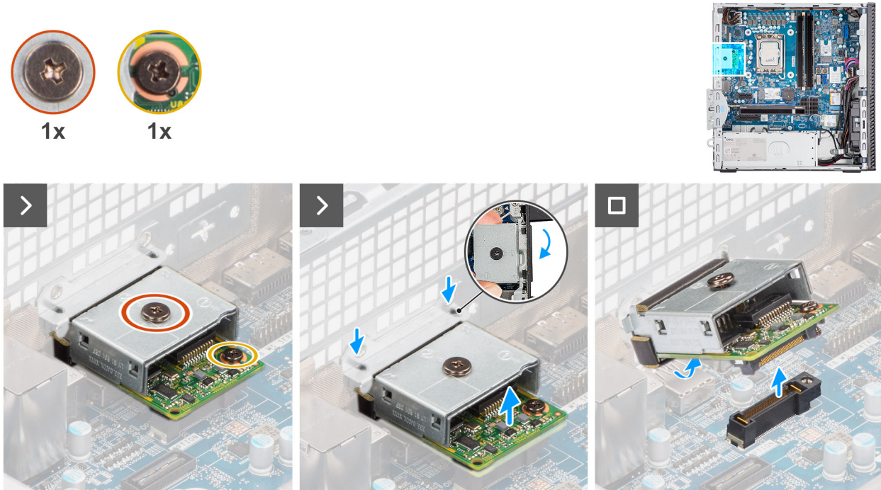
Figure 70. Removing the optional LAN module
