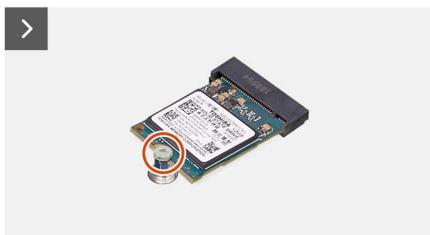
Obrázok 33. Demontáž disku SSD M.2 2230
